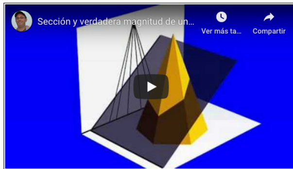
Sección y verdadera magnitud de un plano de canto sobre una pirámide hexagonal. Video de Vicente Pérez Iborra alojado en Youtube
